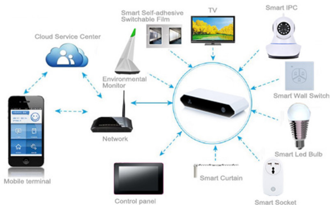
Figura 31 Arquitectura General de un medidor/concentrador eléctrico para el hogar
