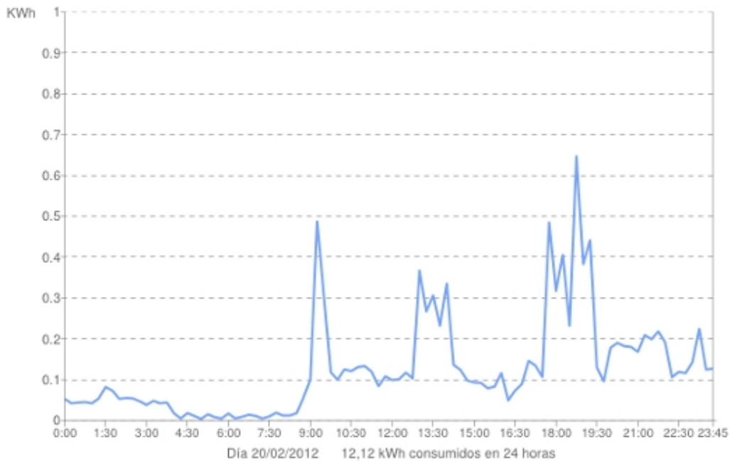
Figura 10 Ejemplo de consumo eléctrico de un medidor eléctrico
